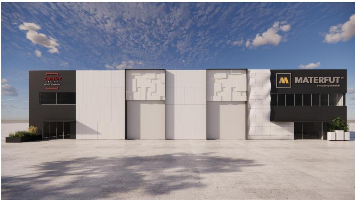
Sede central de Materfut® en Portugal. La fachada con paneles Corian® Exteriors (hechos con Corian® Solid Surface) muestran diferentes posibilidades de formado, incluyendo paneles de formas orgánicas creados con diseño paramétrico; Proyecto del arquitecto Alexandre Sousa Lopes; fabricación e instalación, Materfut®; Imagen Materfut®, todos los derechos reservados.
